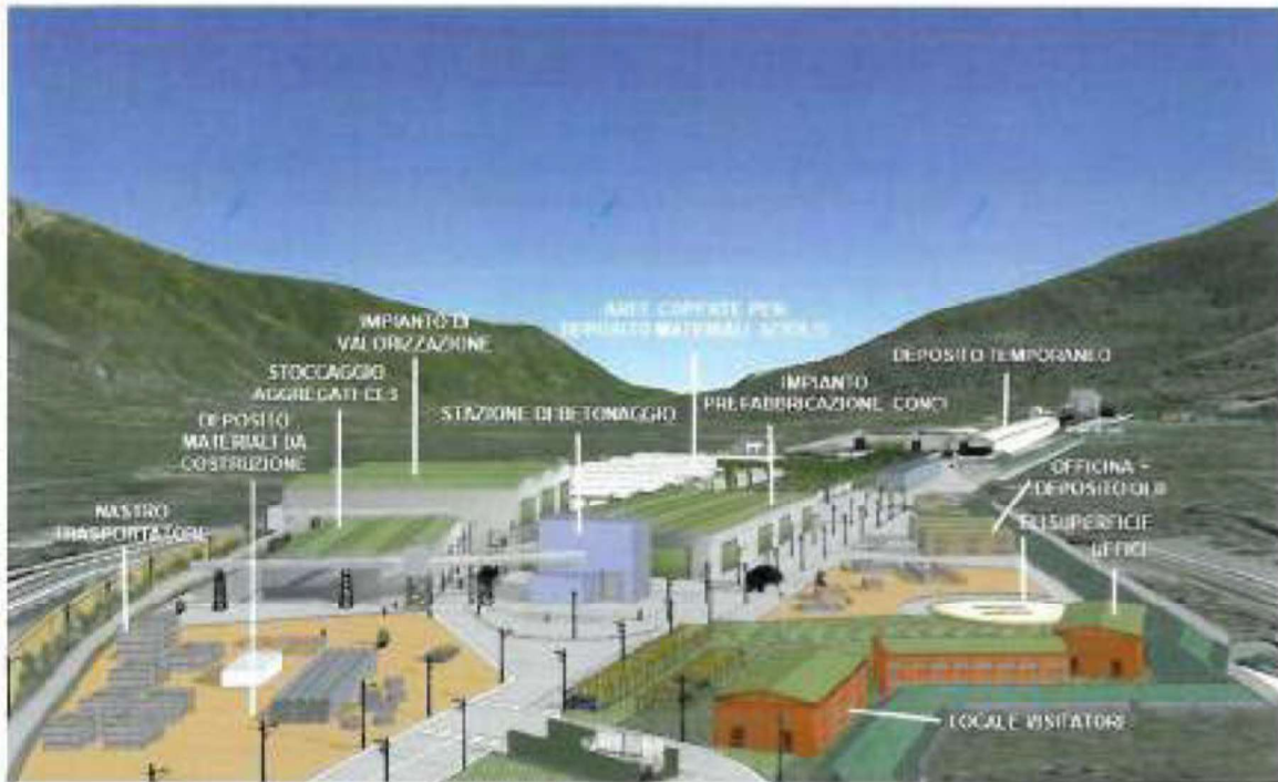
Figura 52 – Render 3D dell'area di cantiere Susa Autoporto
