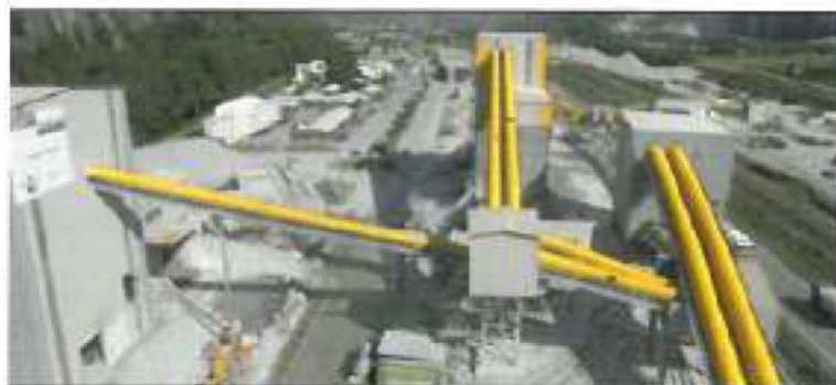
Figura 77 – Cantiere AlpTransit (Pollegio, Svizzera) – Movimentazione dei materiali provenienti dagli scavi e degli aggregati mediante nastri trasportatori (si possono anche osservare sulla sinistra l'impianto di valorizzazione, al centro i silos di stoccaggio degli aggregati e sulla destra la centrale di betonaggio)
